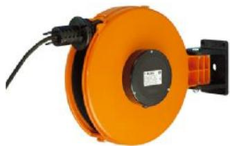
Прочный кабельный барабан с кольцевым токоъемником. Защита от перегрузок посредством плавкой вставки на 10А. Поворотное настенное крепление (потолочное крепление как опция) и замок размотки кабеля с функцией отключения. Тип кабеля: H07RN-F. Без штекера.
