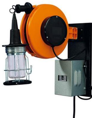
Защита от перегрузок посредством плавкой вставки на 10А. Прочный пластиковый корпус. Включает 250В/24В/100ВА трансформатор, мобильную защищенную лампу 60Вт, настенное крепление и замок размотки кабеля с функцией отключения. Тип кабеля: H05VV-F.
