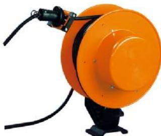
Кабельный барабан для больших нагрузок. Предлагается с 25А или 40А кольцевым токоъемником. Тип кабеля: H07RN-F. В комплекте: настенное крепление (потолочное крепление как опция) и замок размотки кабеля с функцией отключения.
