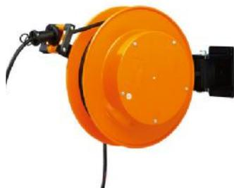
С 3-/5-/7-/10- или 20 контактным кольцевым токоъемником. Предохранитель на 10А. В комплекте: поворотное настенное крепление (потолочное крепление как опция) и замок размотки кабеля с функцией отключения.
